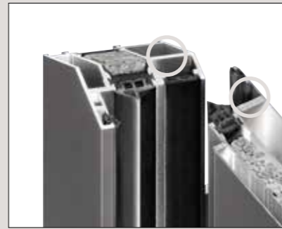
Wandungsstärke bis 3 mm bietet einen sicheren Halt für Schloss und Bandbolzen
